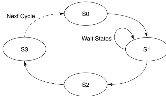
**Figure 33-25. Data-Transfer-State-Transition Diagram**
