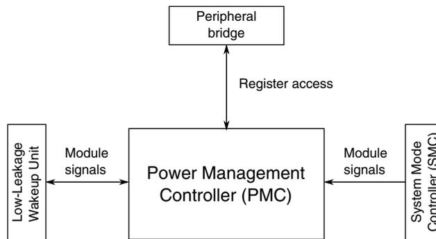
**Figure 3-8. PMC configuration**
