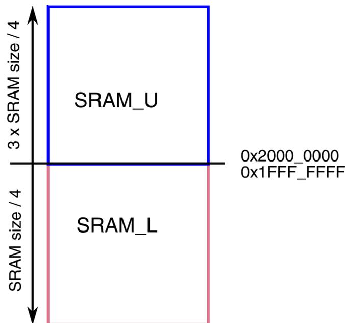
**Figure 30-3. SRAM Arrays**
