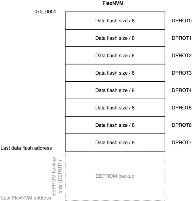
**Figure 32-7. Data flash protection (2<sup>n</sup> data flash sizes)**
