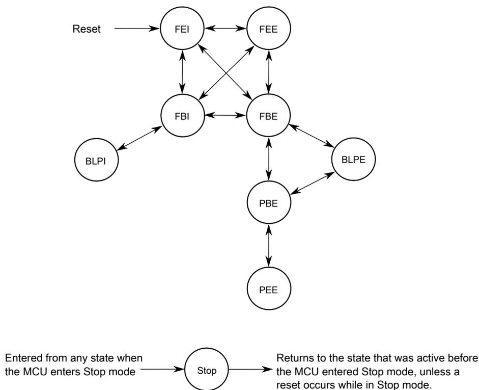
**Figure 20-2. MCG mode state diagram**
