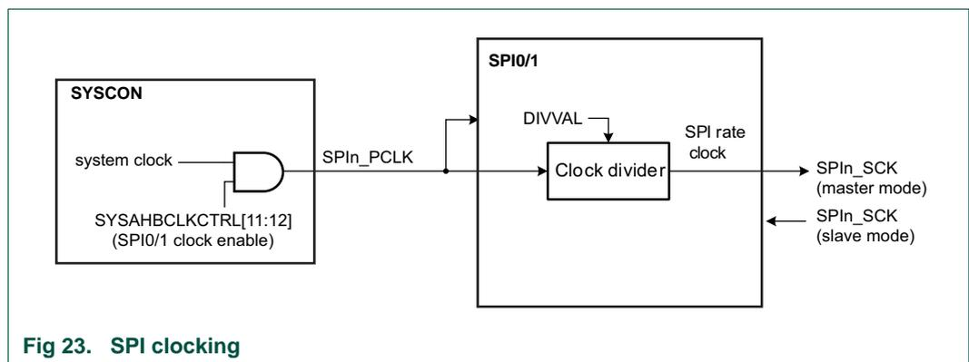
Fig 23. SPI clocking
