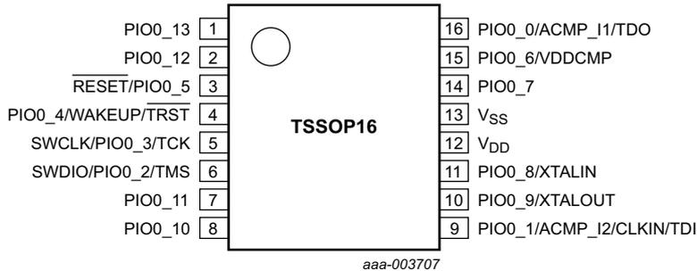
Fig 3. Pin configuration TSSOP16 package (LPC811M001JDH16 and LPC812M101JDH16)
