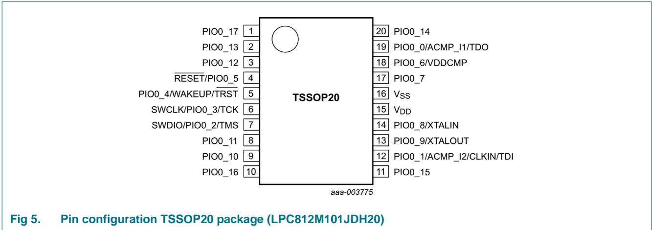
Fig 5. Pin configuration TSSOP20 package (LPC812M101JDH20)
